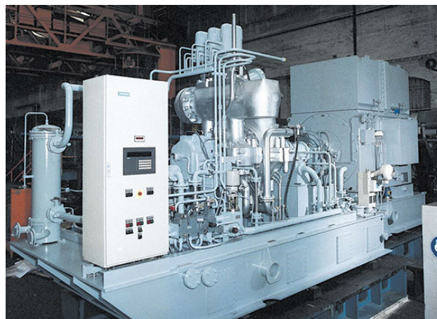
989 Turbosoustrojí s parní turbínou a základním příslušenstvím na společném rámu Označení tohoto turbínového kompletu je SST 100. Parametry: výkon až 8,5 MW; vstupní tlak páry až 6,5 MPa; teplota vstupní páry až 480 °C; rozměr 8x3,7 m při výšce 3,4 m. Výrobce: Siemens AG. Zdroj: [21].
