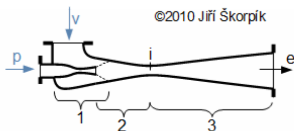
112 Obecné schéma ejektoru nebo injektoru
